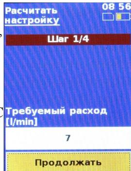
3. Во втором окне можно прочесть начальный расход и начальную настройку, которую можно изменить после нажатия на кнопку **ОК** (процедура описана в параграфе измерения настройки клапана). После выполнения возможных изменений можно вернуться ко второму окну или продолжить, переходя на **Продолжить** и нажимая на кнопку **ОК**.
